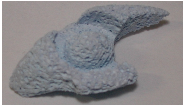
Prove di fresatura idrossiepatite
