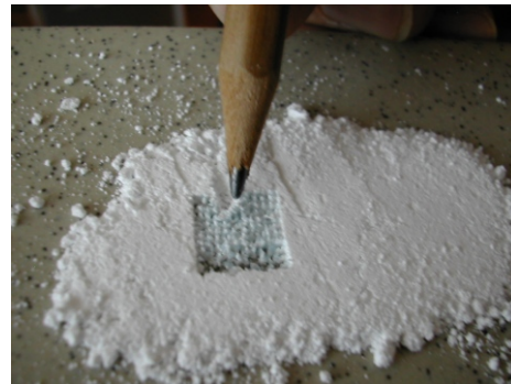
Prova di stampa tridimensionale in idrossiepatite con amido o polivinil alcool
