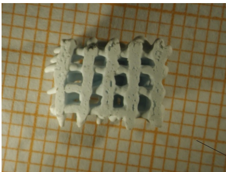
Realizzazione supporto in idrossiepatite tramite processo di estrusione
