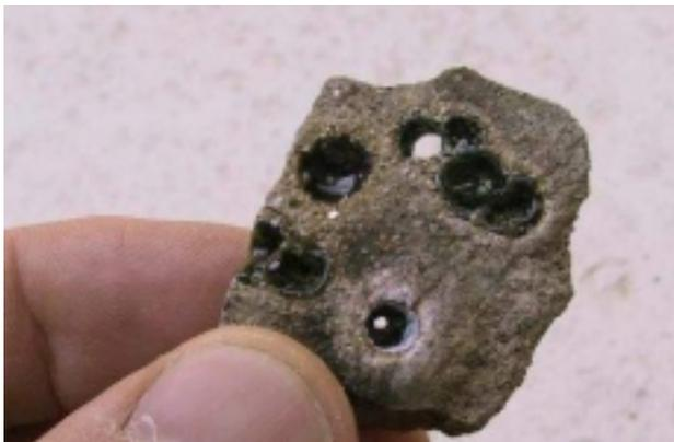
Il nostro dubbio sulla sinterizzazione laser era che HA potesse ossidarsi producendo una sinterizzazione simile al campione qui a lato. Detto dubbio è stato completamente fugato, ora sappiamo che è possibile sinterizzare con laser l'HA
