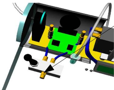
La valvola seleziona quali dei due tubi mandare in uscita . Nell' uscita è inserito lo stetoscopio così che spostando la leva a destra o a sinistra si seleziona la protesi di destra o di sinistra.
