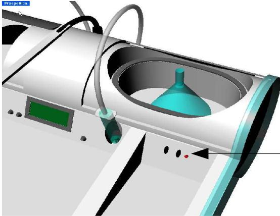
Nel vano di destra è montata la vaschetta ad ultrasuoni che si accenderà con un pulsante temporizzato a 3 minuti un led indica che la vaschetta sta funzionando
