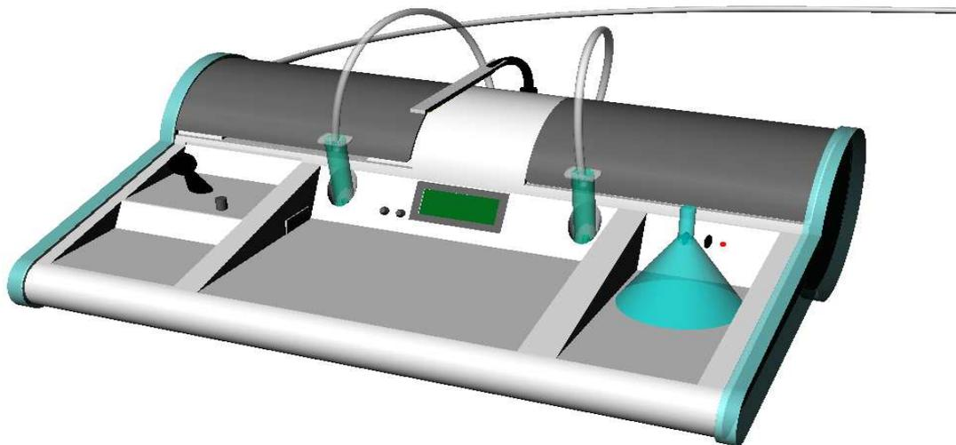
La siringa di sinistra soffia e la siringa di destra aspira l'estrazione della siringa fa partire il compressore automaticamente senza la necessità di un interruttore.
