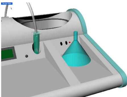
In posizione di riposo l'imbuto può essere riposizionato all'interno della vaschetta oppure sul vano laterale al piano centrale
